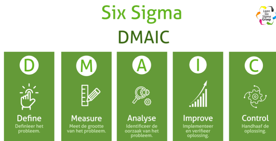
Figuur 2: Overzicht van de stappen in het DMAIC model (Lean Six Sigma Groep, 2023).
